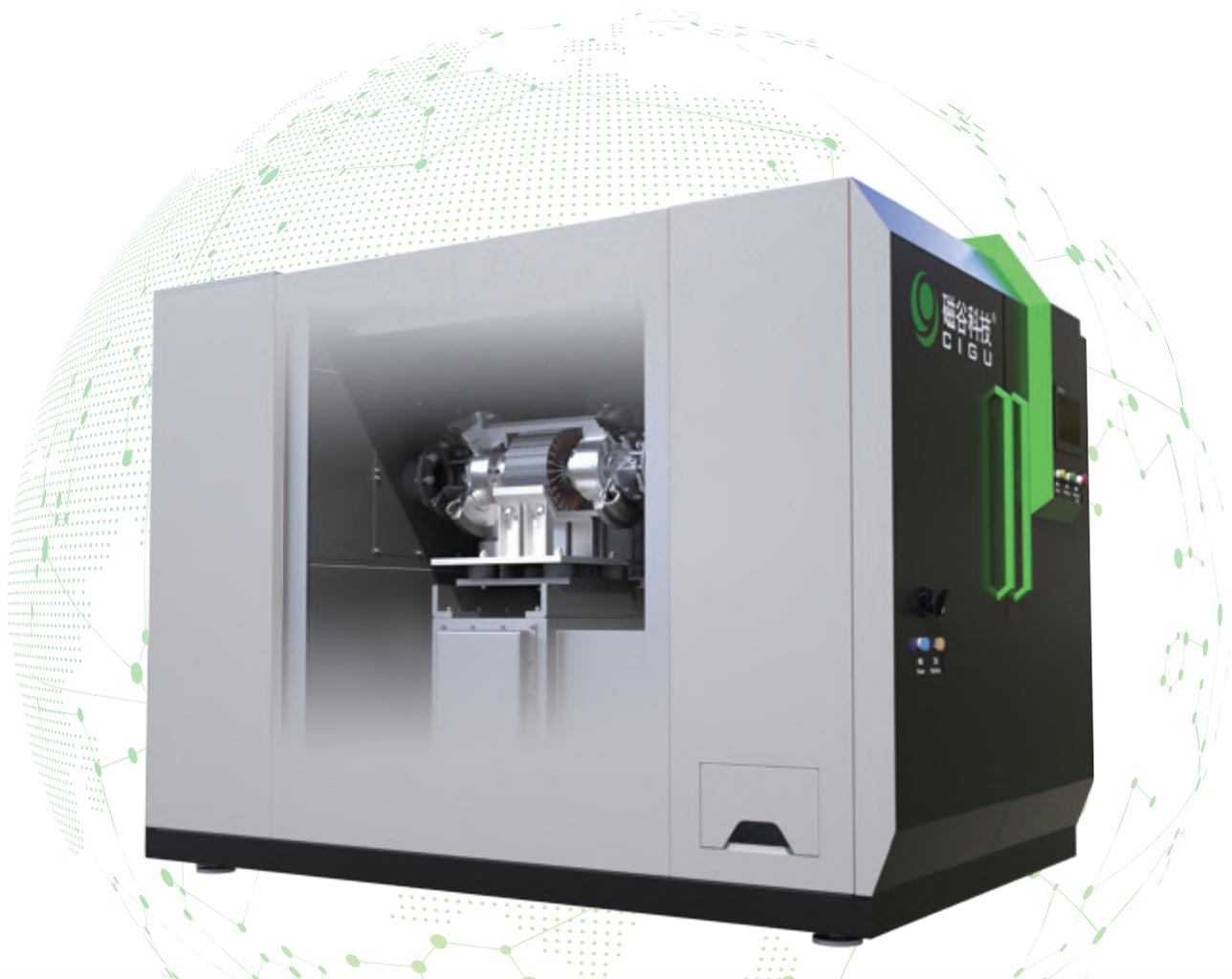
磁悬浮空气压缩机是磁谷科技自主研发的一款新型高效无油压缩机。与传统压缩机相比，该产品无需增速齿轮箱，可节能约20%；无需润滑，100%无油；低噪音 $\leq 75\text{dB(A)}$ 、低振动；易安装、易维护；自主研发，可提供定制服务。
